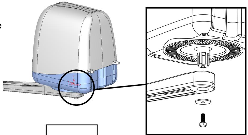
Portare l'anta fino a battuta e marcare il punto di fissaggio della piastra attacco leva al cancello
