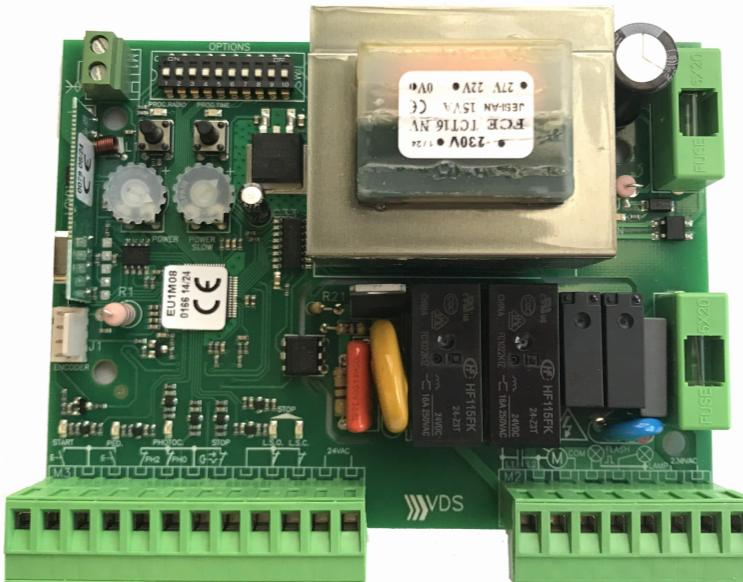
Apparecchiatura di comando 1 Motore 230Vac
