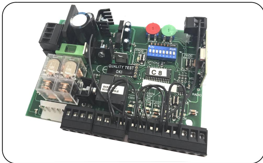
Apparecchiatura di comando 1 Motore 24Vdc
