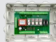
COD. 93330000 Carte électronique pour le contrôle de 4 moteurs à homme mort - Sans récepteur radio
