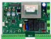
CODE E102/P Carte électronique E102 avec logiciel borne + récepteur
